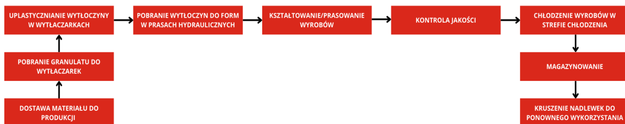
Rysunek 4.1: Uproszczony schemat produkcji wyrobów budowlanych i infrastrukturalnych z recyklatowych tworzyw sztucznych
